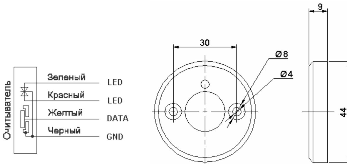
\* Производитель оставляет за собой право изменить цвет проводов. В этом случае распиновку можно определить с помощью тестера согласно вышеприведенной схеме.
